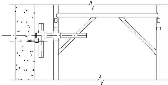
**ANCORAGGIO " tipo B " CON TUBO Ø 48.3 x 3.2
