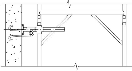
**ANCORAGGIO " tipo A " CON TUBO Ø 48.3 x 3.2
